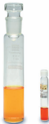
Porovnání množství chemikálií používaných při standardní metodě a v kyvetovém testu.
