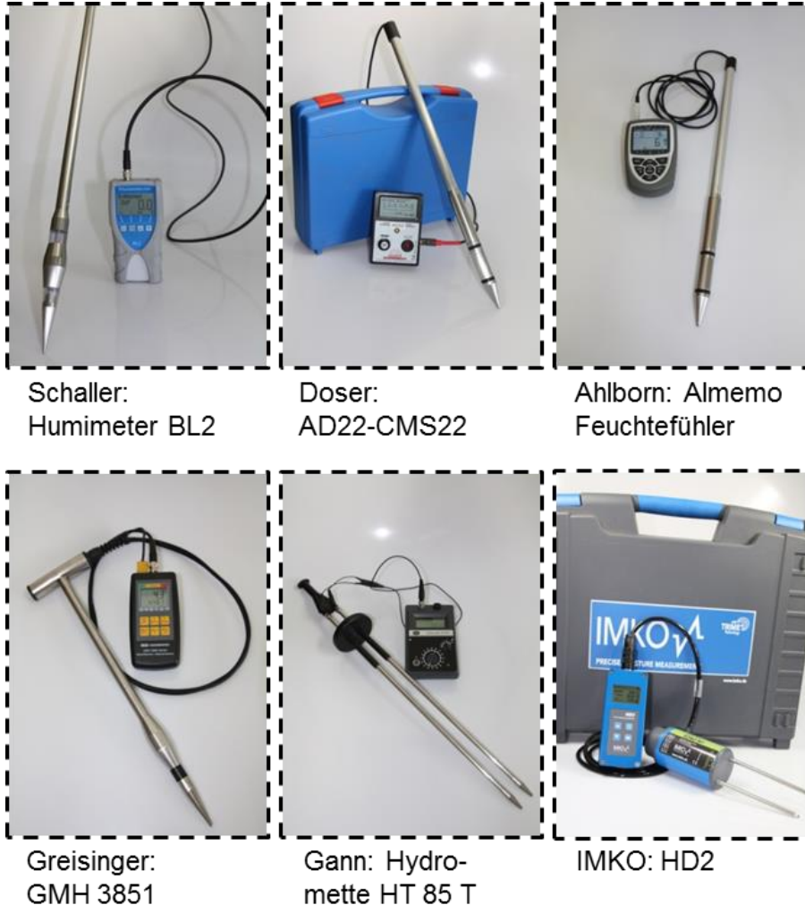
Abbildung 4: Einstechlanzen: humimeter BL2, AD22-CMS22, Almemo Feuchtefühler, GMH 3851, Hydromette HT85T, HD2
